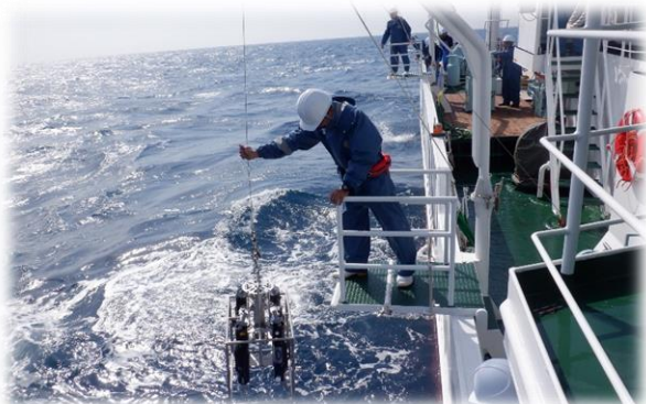
〈写真〉CTD採水器による海洋観測
